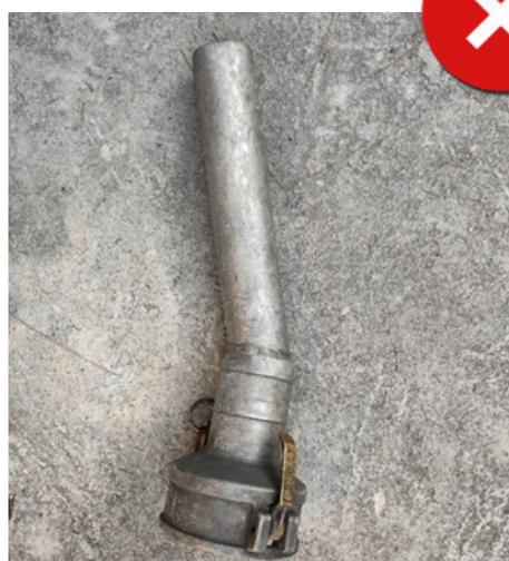
O cachimbo, imagem a esquerda, só pode ser usado como dispositivo de descarga selada em tanque subterrâneo. O "bico de pato", imagem a direita, não pode ser utilizado em tanques aéreos ou subterrâneos.
