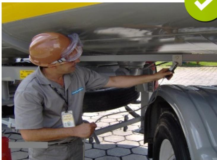
Como medida de transição até a adequação do aterramento, deverá ser realizada a equalização potencial através de um ponto metálico (sem pintura) de conexão ao tanque.
